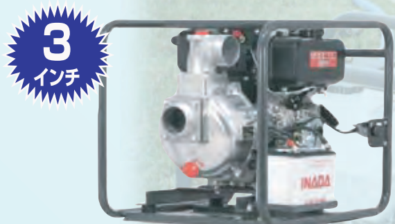
QP-305SLD (KUBOTA OC62) 最大揚程: 55m 最大吐出量: 470ℓ/分 QP-305SLD (YANMAR L70) 最大揚程: 60m 最大吐出量: 450ℓ/分
