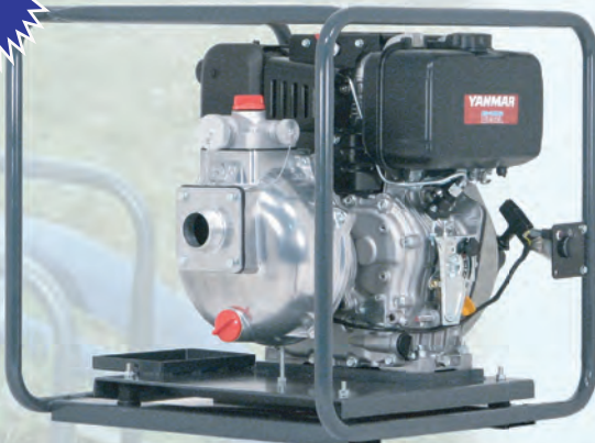
QP-T205SLTD (KUBOTA OC95) 最大揚程: 85m 最大吐出量: 420ℓ/分 QP-T205SLTD (YANMAR L100) 最大揚程: 90m 最大吐出量: 450ℓ/分
