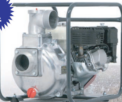
QP-305S (HONDA GX160) (MITSUBISHI GB18G) 最大揚程: 70m 最大吐出量: 480ℓ/分
