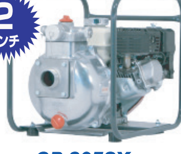
QP-205SX (HONDA GX160) 最大揚程: 90m 最大吐出量: 350ℓ/分
