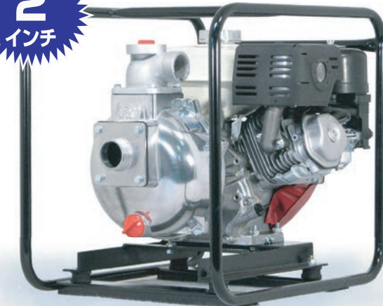
QP-T205SLT (HONDA GX270) 最大揚程: 95m 最大吐出量: 480ℓ/分
