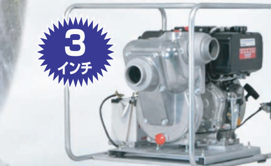
AQP-310SXD (KUBOTA OC95) 最大揚程: 60m 最大吐出量: 700ℓ/分
